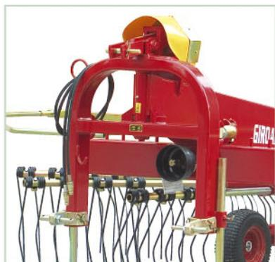
L'attacco a 3 punti orientabile, mantiene l'andana soffice ed uniforme anche nei cambi di direzione.
